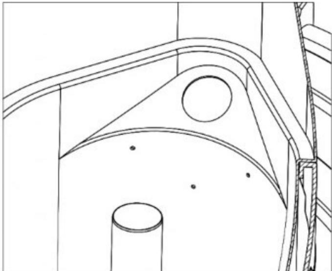
4. Закрепить насосный отсек на септике с помощью болтов и гаек. Гайки затянуть гаечным ключом на 17мм, просунув руку через отверстие в септике.
