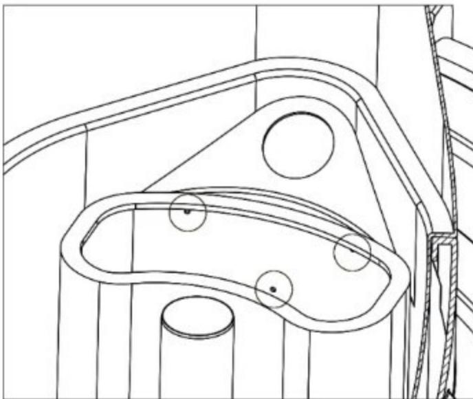
3. В отмеченных точках просверлить отверстия в септике сверлом 10 мм.
