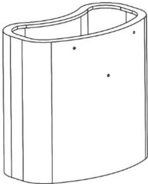
2. Опустить насосный отсек внутрь септика. Через отверстия в насосном отсеке сделать маркером три отметки на септике.
